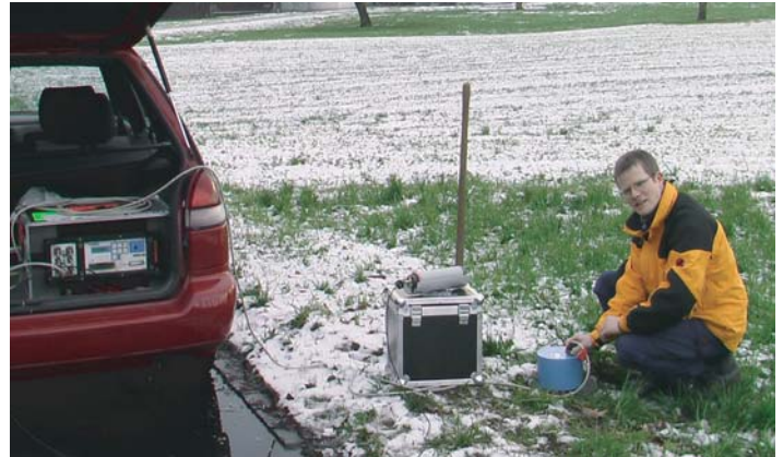
Abb. 3: Eine seismische Messung am Stassenrand (Anmerkung: der blaue Topf ist das Seismometer)
