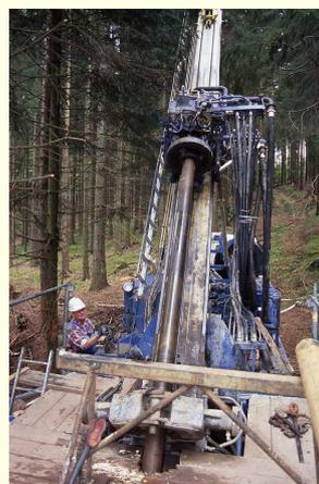
Abb. 3: Schrägbohrung bei Freudenstadt zur Erkundung der mineralisierten Randstörung des Freudenstädter Grabens auf ihr Fluss- und Schwespatpotenzial
