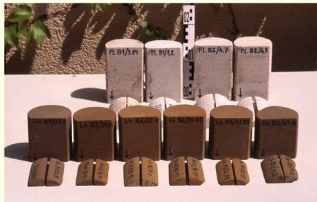
Abb. 2: Bohrkernproben aus dem Eisensandstein (vorne) und dem Stubensandstein (hinten), vorbereitet für die petrographische, geochemische und gesteinsphysikalische Analyse zur Prüfung ihrer Tauglichkeit als Austauschmaterial für denkmalgeschützte Gebäude
